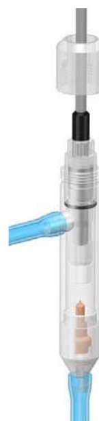
Рис. 2.5. Фиксация АСрО 2 в измерительной камере
